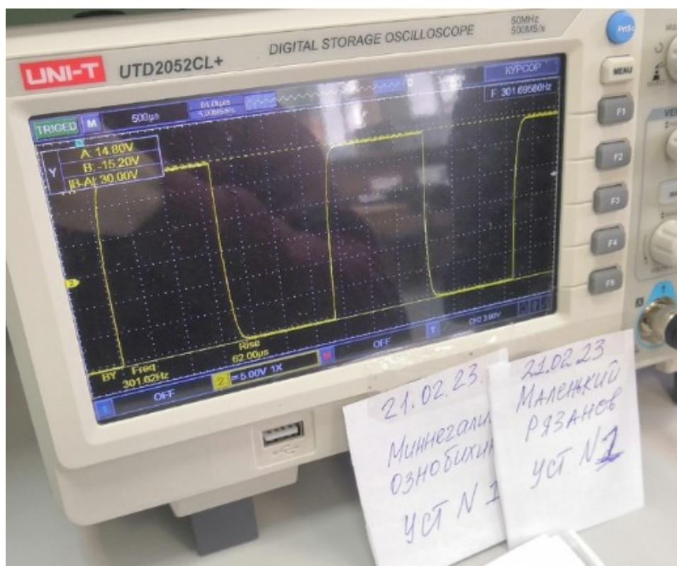
Рисунок 5 Осциллограмма дифференциального выходного сигнала мультивибратора
