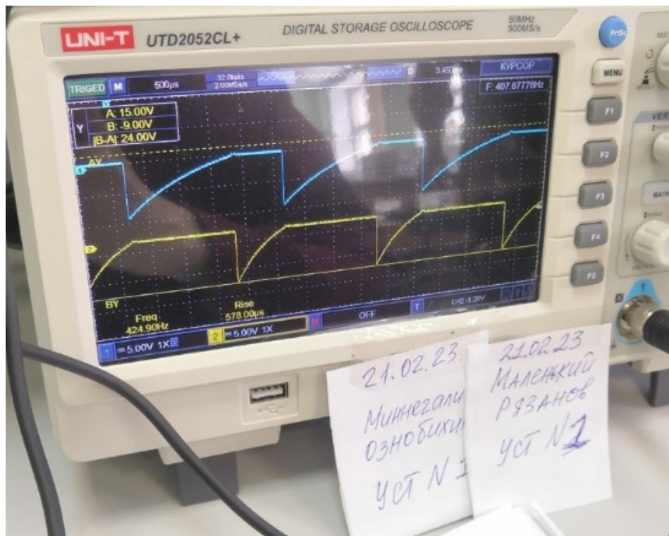
Рисунок 4 Осциллограммы для базы 1 транзистора и базы 2-го транзистора
