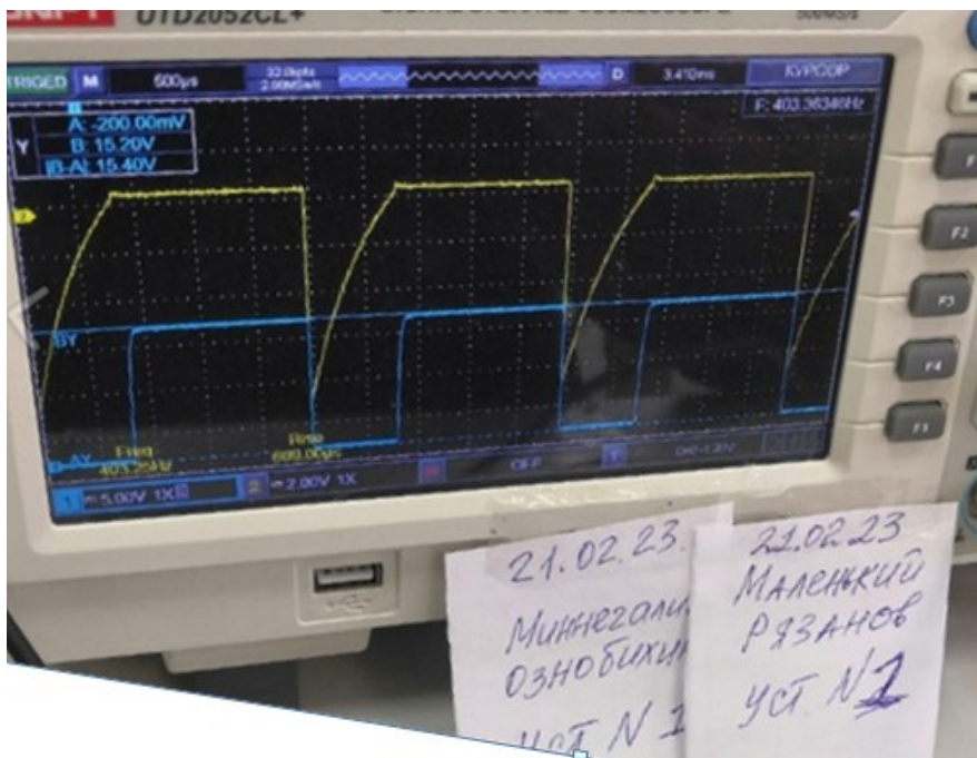
Рисунок 3 Осциллограммы для коллектора 1 транзистора и базы 2-го.
